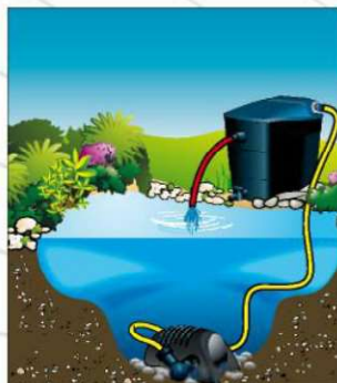
Powermax in de vijver, aansluiting aan drukzijde naar het filter
